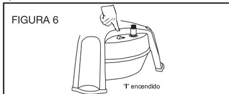
Cuando se termine de utilizar el equipo se coloca en la posición de apagado el equipo "0" (off).
