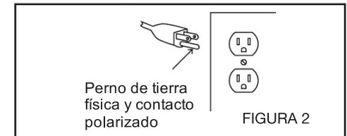
Perno de tierra física y contacto polarizado
