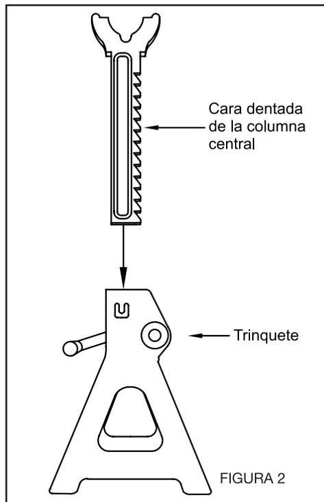
2.- Después de haber insertado la columna central, se deberá doblar la tablilla de metal (Ver figura 3), esto evitara que la columna central se separe del resto del soporte
